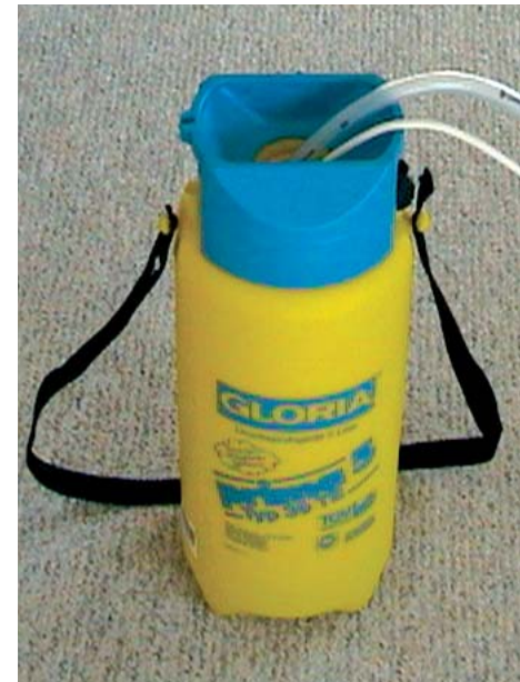
Wassertank eines Drucksprühergeräts als Vorratsbehälter für die Camping-Tauchpumpe zweckentfremdet Foto: Thorsten Gurzan
